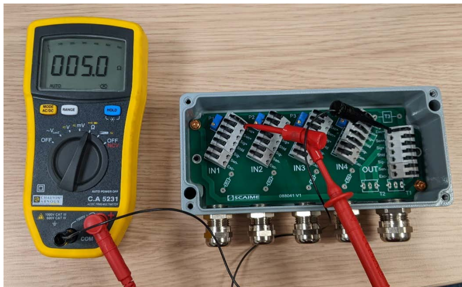
Fig 3. Test d'impédance et affichage du résultat
